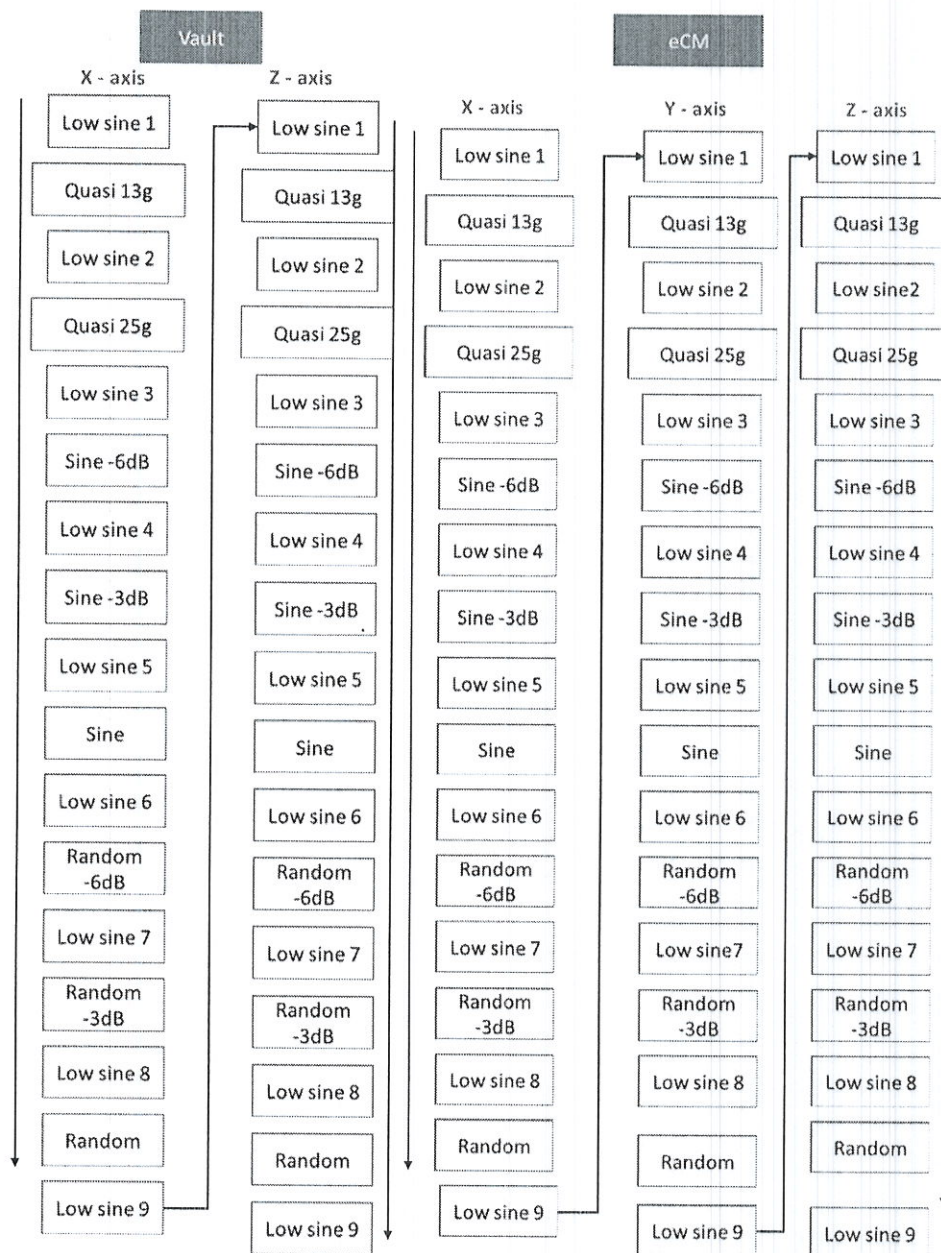
Fig. 30 – Schema plan testare vibratii si soc
